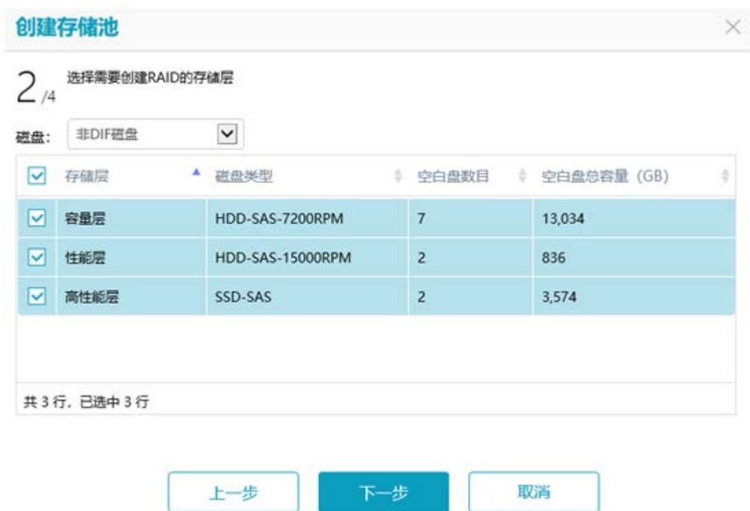
图5-2 创建启用自动分层的存储池界面（二）
