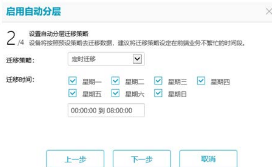
图5-6 启用自动分层（定时迁移）向导界面
