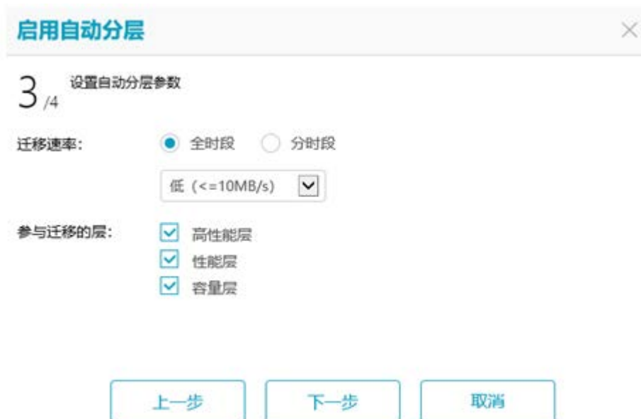
图5-7 设置自动分层参数向导界面
