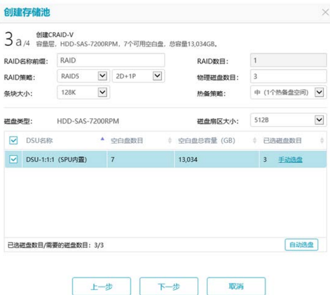
图5-3 创建启用自动分层的存储池界面（三）
